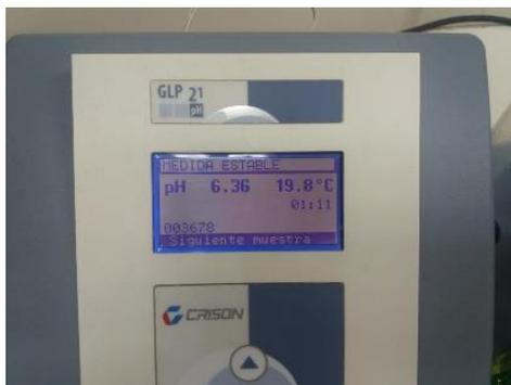
Resultado del pH de la muestra hidroalcohólica
