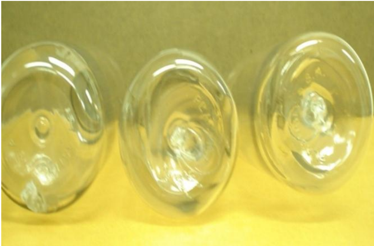
Figura 8, PUNTO DE INYECCIÓN DESCENTRADO.
