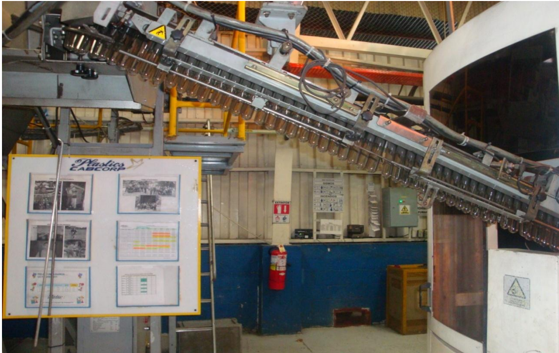
Figura 6, proceso de transporte de la preforma al horno de calentamiento.
