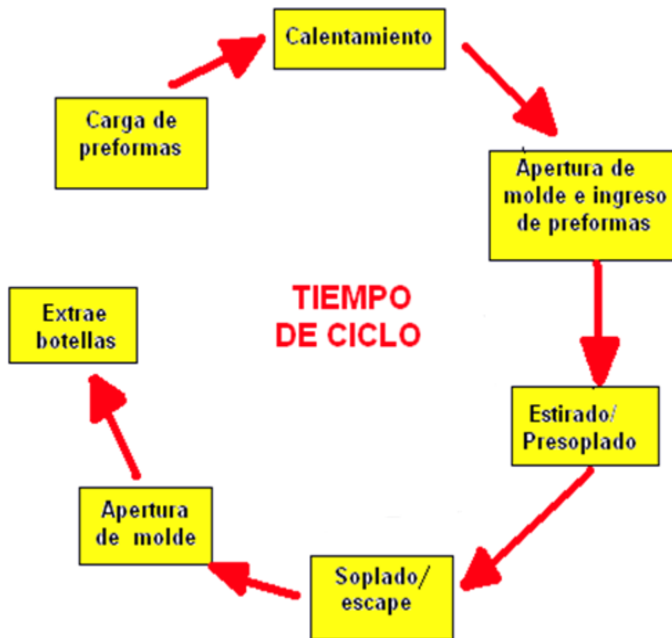
7 diagrama de flujo del Proceso de Soplado
