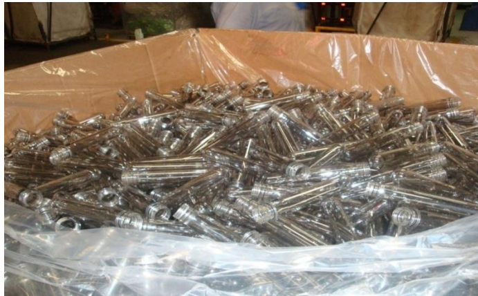
FIGURA 2, ACONDICIONAMIENTO DE LA PREFORMA
