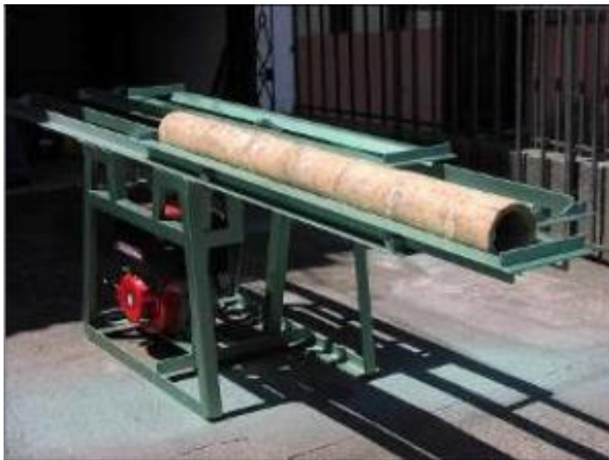
Figura No. 17 Sierra paralela para latillar
