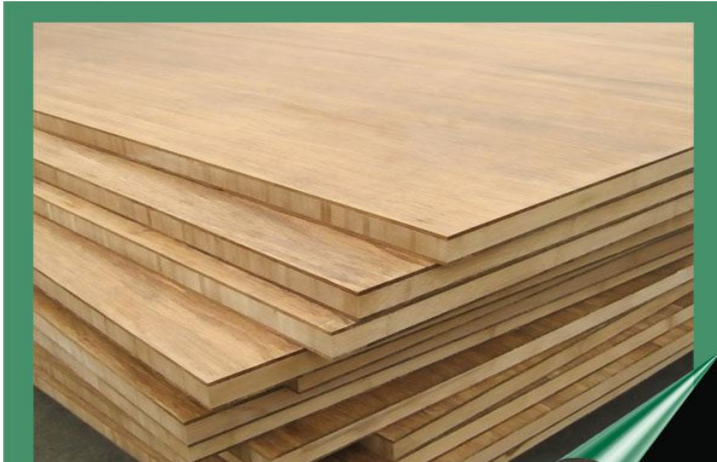
Figura No. 13 Tableros enlistonados y vigas laminadas
