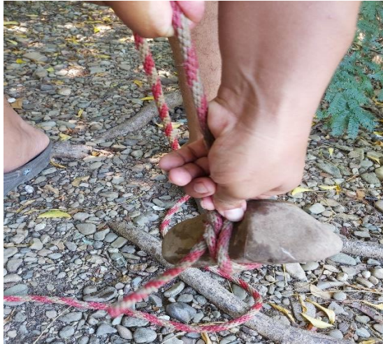
Foto N°.5 Instrumento para medir profundidad
