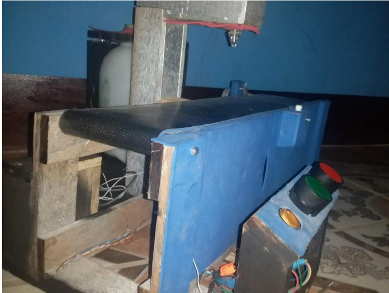
Imagen de botones de Stop, Start y paro de emergencia.
