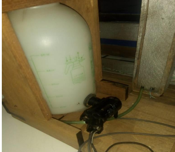
Figura 7.8 motor y recipiente para llenado automatizado.
