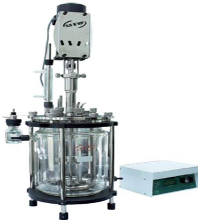
Figura 5.21. Fermentador básico con agitación mecánica
