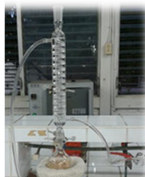
Fig 18.3.1 Sistema de reflujo para extracción de la muestra líquida
