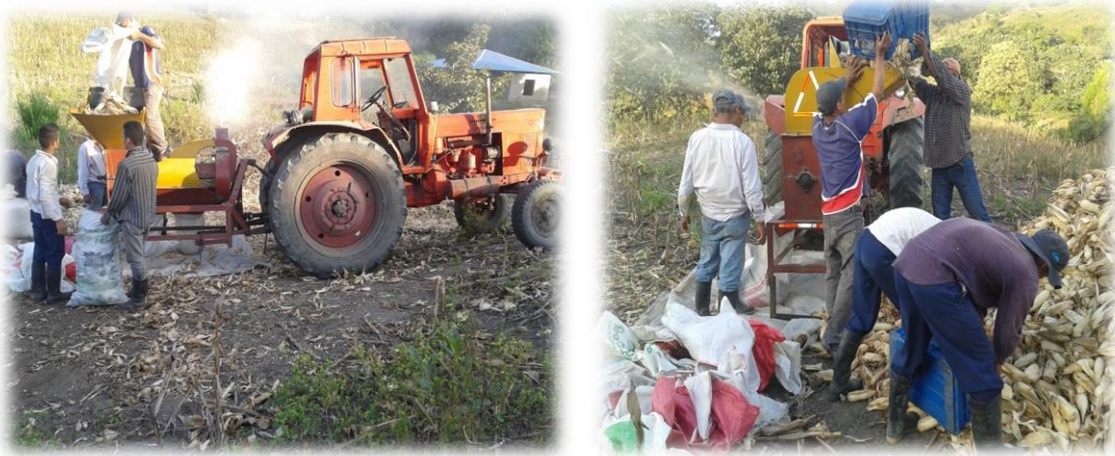
Figura 9.2.6 Extracción mecánica del maíz
