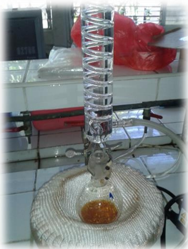
Fig 18.6.1 Extracción a reflujo
