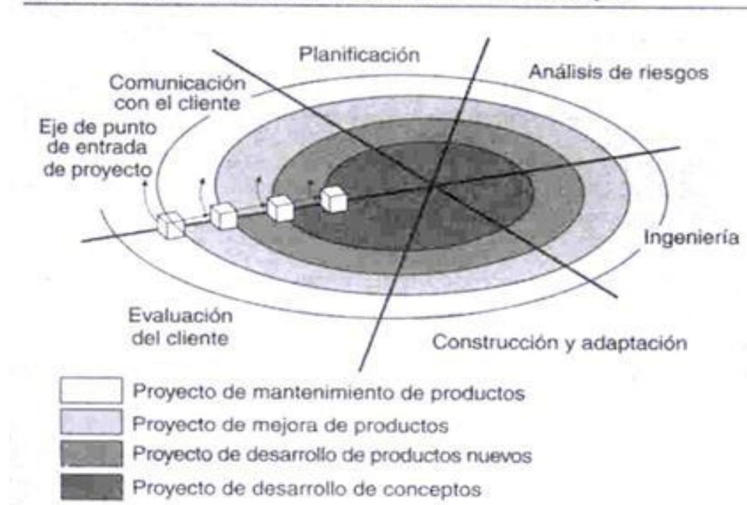
Figura 13 - Modelo en Espiral adaptado para el ciclo de vida clásico completo
