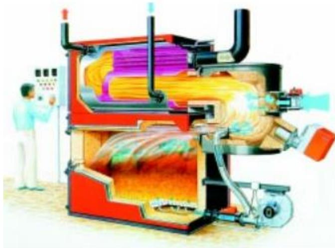
Figura 5. Incinerador de doble cámara convencional
