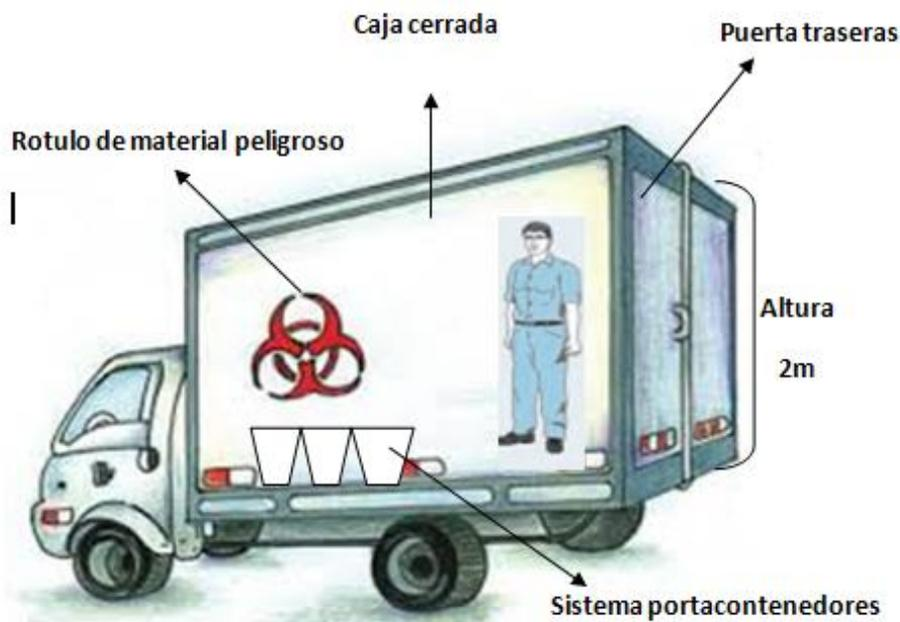
Figura 22. Características del camión recolector.
