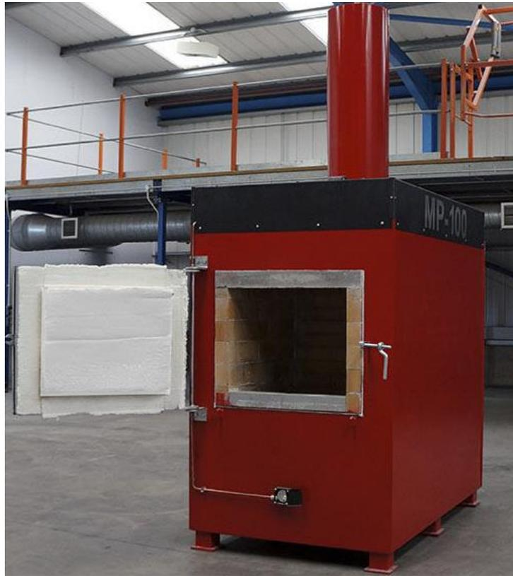
**Figura 23. Incineradora MP 100**
