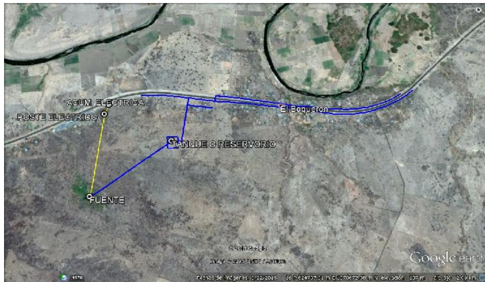
FIGURA 7. Línea de distribución. Fuente. Elaboración propia
