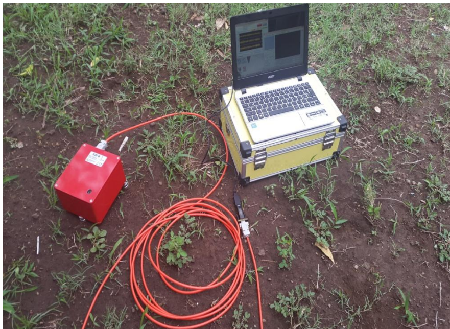
ANEXO C.1. Sismógrafo triaxial SR04S3 marca SARA.
