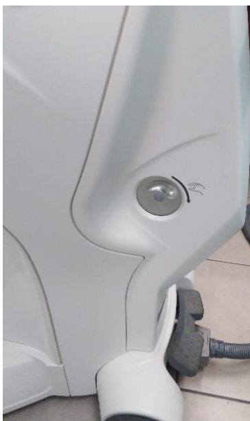
Figura 27. Manivela retorno manual de la fuente
