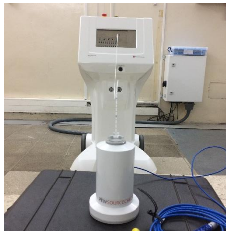
Figura 33. Medición tasa de referencia Kerma en aire mediante cámara de pozo.
