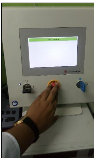
Figura 17. Accionamiento botón parada de emergencia.
