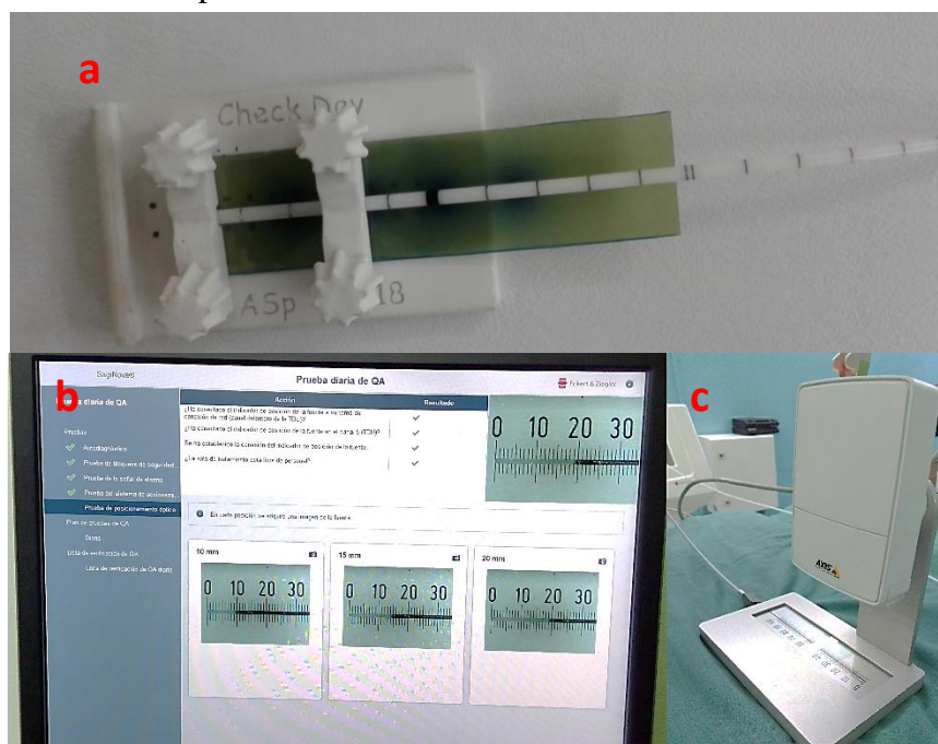
Figura 30. Posicionamiento de la fuente, a) Método autorradiográfico, b) y c) método óptico.
