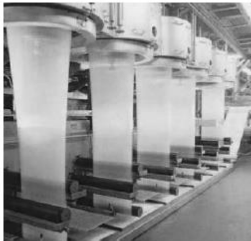
Ilustración 7. Proceso continuo. Extracción del textil
