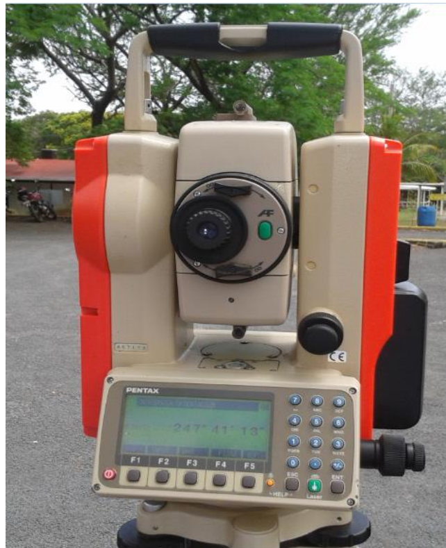
FIGURA 5 estación total PENTAX modelo R-315N
