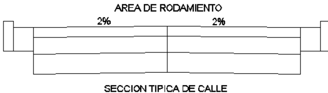
FIGURA 22: sección transversal de calle
