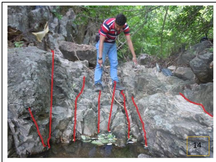
**Foto 15. Las líneas de color rojo indican el fracturamiento paralelo, quebrada La India con coordenadas (E573419 / N1406390).**
