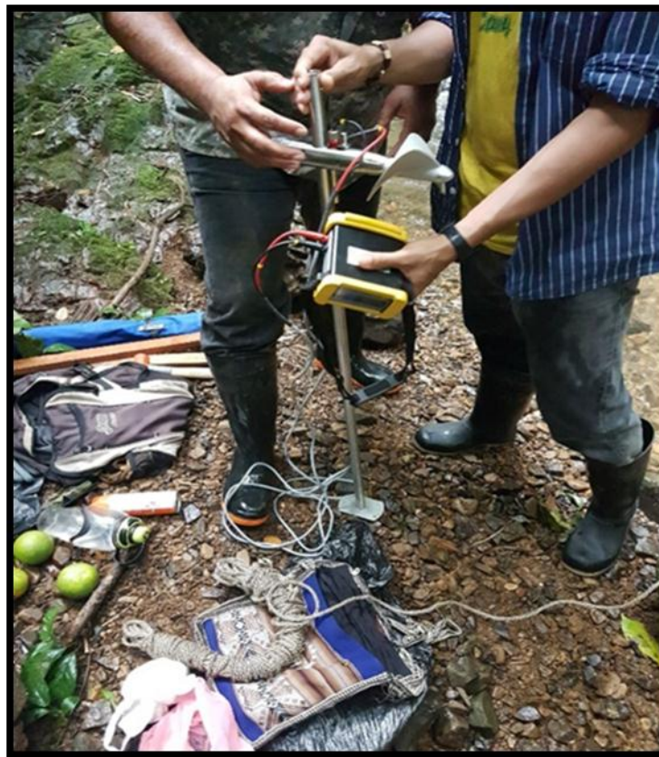
Foto 26. Molinete hidrométrico C31 equipo utilizado para determinar la velocidad del agua.
