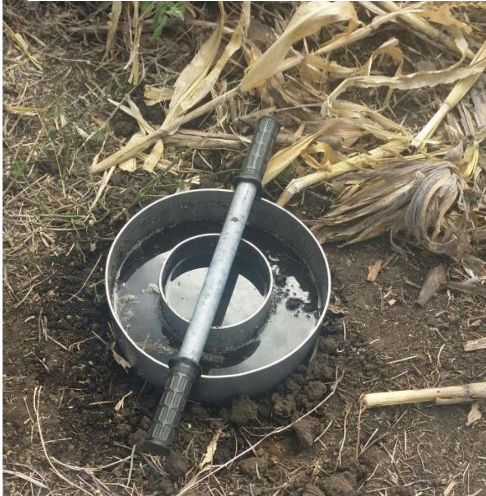
Figura 3. Medición de velocidad de infiltración Básica
