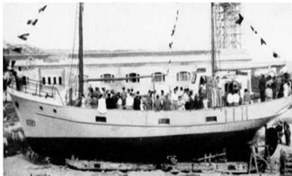
Figura 1. Embarcación construida con ferrocemento por Pier Luigi Nervi. Fuente: Conceptos generales de ferrocemento.
