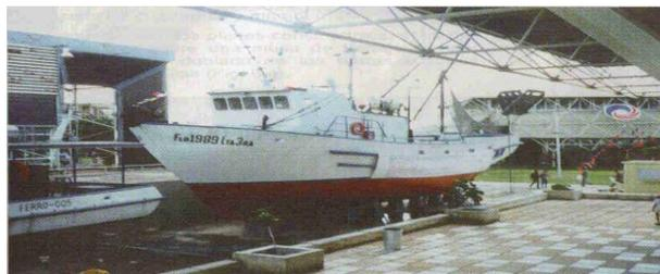
Figura 15. Construcción de barcos con ferrocemento, uno de los primeros diseños a base de dicho material. Fuente: Centro Panamericano de Ingeniería Sanitaria y Ciencias del Ambiente.
