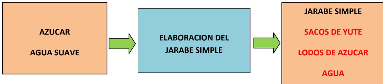
**Figura 4. Diagrama de caja negra del proceso de elaboración del jarabe terminado.**
