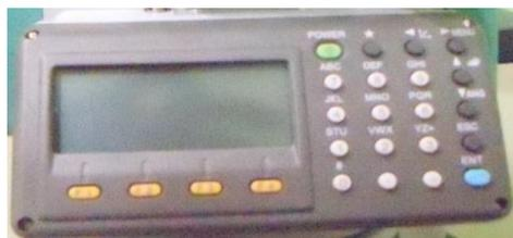
La Estación Total SOKKIA es un instrumento que puede Medir, Calcular y Guardar, Coordenadas, Ángulos y Distancias partiendo de métodos implementados en la Topografía Clásica, simplificando el trabajo y evitando los riesgos de los sitios peligrosos y/o inaccesibles.
