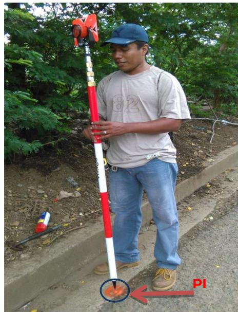
Se establecieron 6 puntos los cuales conformaran la red secundaria utilizando estación total sokkia TOPCON, partiendo de 2 geodésicos con coordenadas conocidas y oficiales, lo que nos garantizó de inicio la calidad en cuanto a precisión, ajuste y georeferenciación.
