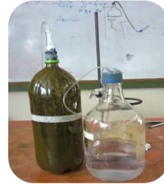
Sistema de bioconversión ya instalado
