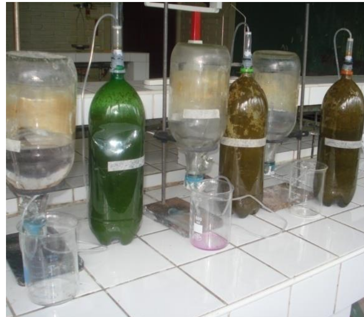
Anexo 42: Biodigestores generando biogás
