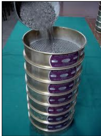
Figura 3. La figura muestra el juego de mallas o tamices que se utiliza para separar una muestra de suelo.
