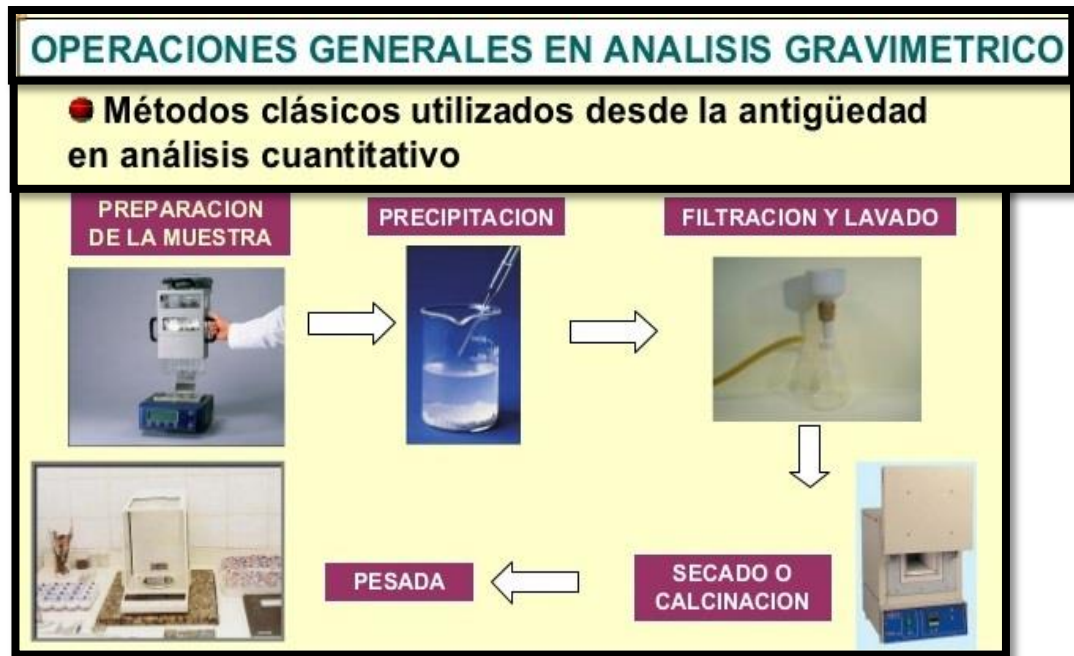
Figura 2. La figura muestra parte de los materiales usados para el análisis de un ensayo Gravimétrico así mismo ilustra el resumen del procedimiento que se realiza.
