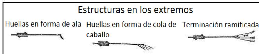
Figura 4. Estructuras en las terminaciones de las fracturas.
