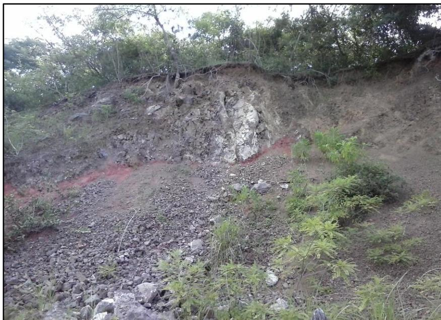
Foto 10. Corte de andesita meteorizada.
