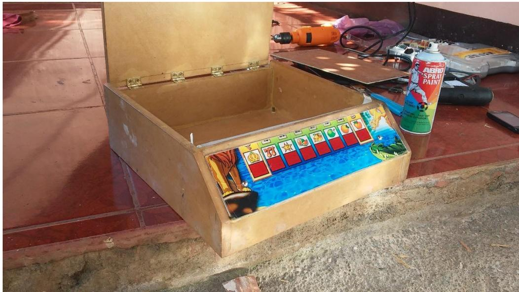
Figura 3, 45 aplicación del barniz para madera y montaje del acrílico
