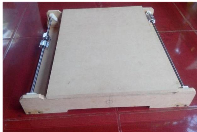
Figura 3, 56 Estructura del eje x de la cnc.
