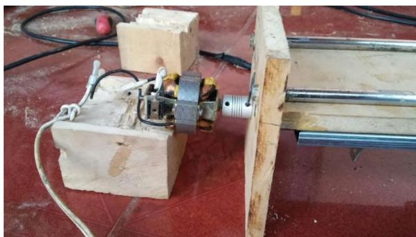
Figura 3, 76 Motor AC utilizado en el sistema de impresión serigráfica
