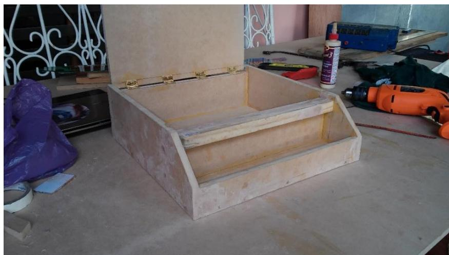
*Figura 3, 44 Ensamble de la tapa, división entre circuitería y Leds, relleno con macilla.*
