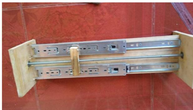
Figura 3, 77 Ensamblaje de la varilla roscada
