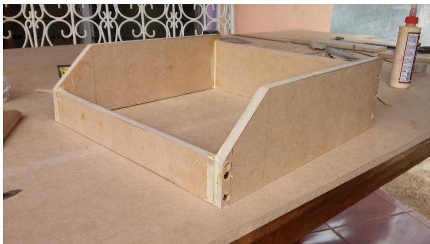
*Figura 3, 43 Montaje de la estructura de la insoladora*
