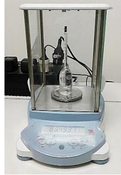
3. Acondicionamiento de la temperatura de la masa de prueba.
