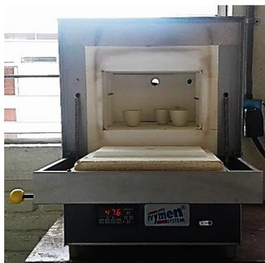
4. Medición de la masa de la muestra incinerada (Cenizas).
