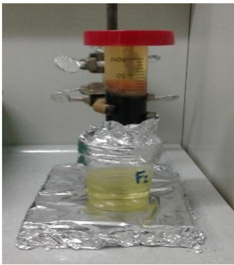
Figura 7.1. Filtración con carbón activado. Esta última imagen corresponde a la operación unitaria por adsorción utilizando carbón activado para eliminación de olor y clarificación del aceite.
