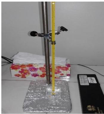
*Figura 3.3.* Medición de la temperatura en el volumen de agua
