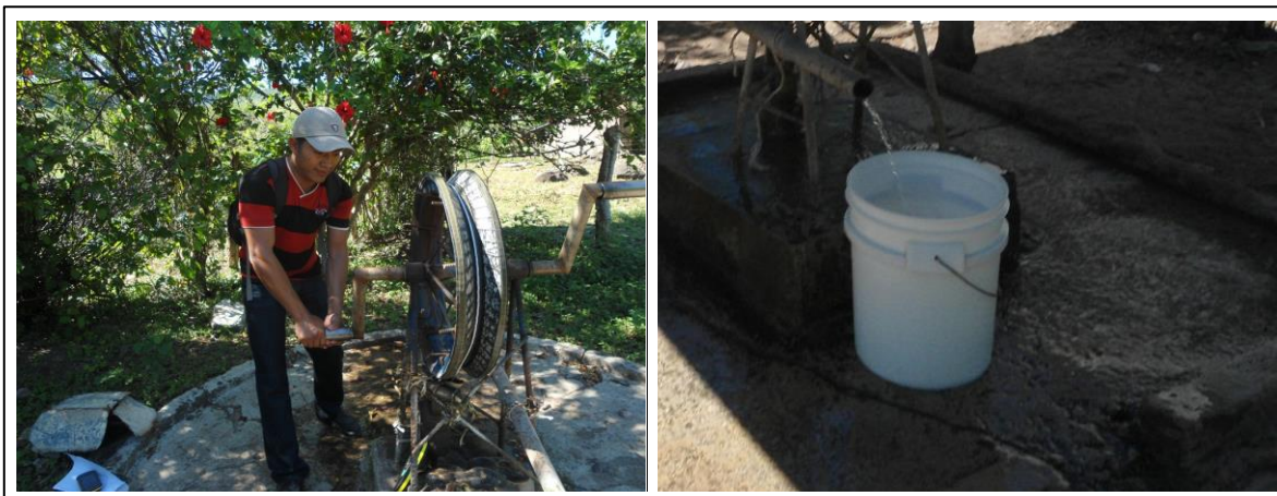
Figura 12: Medición del caudal de extracción por bombeo manual. Fuente: Elaboración propia. (2014).
