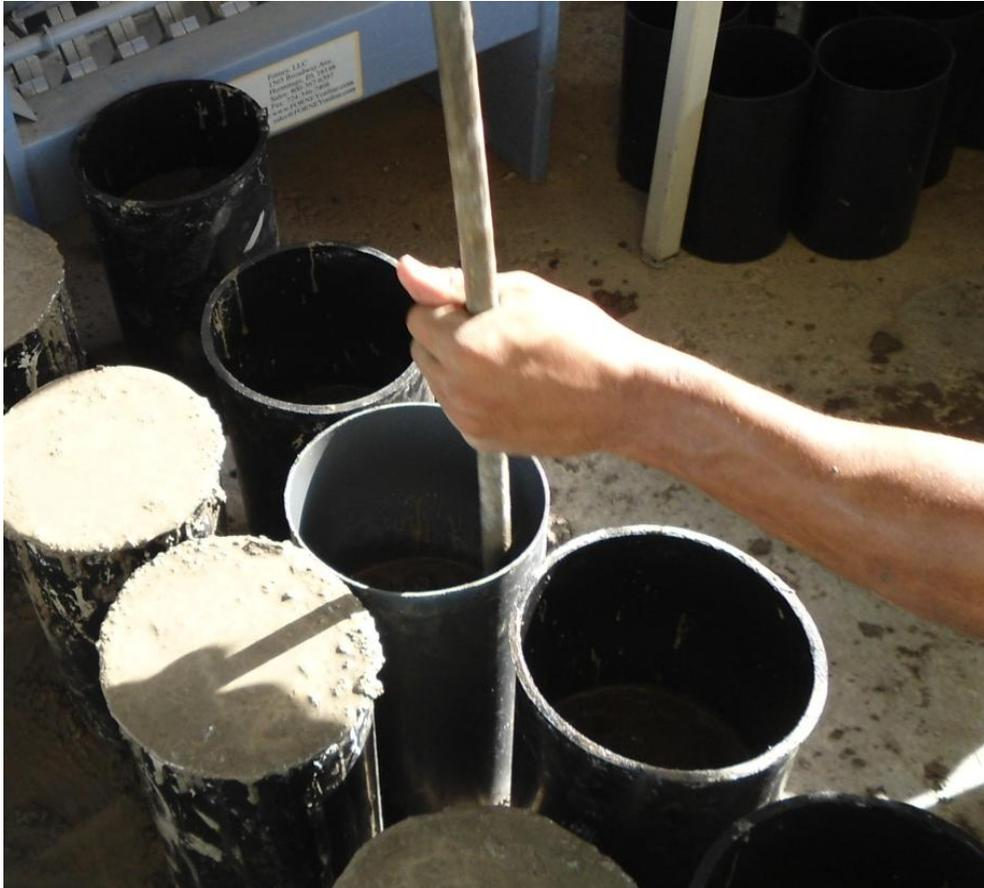
Figura 30. Moldes Plásticos usados en la fabricación de Muestras.
