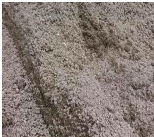
**Figura 5. Agregado fino o Arenas.**
