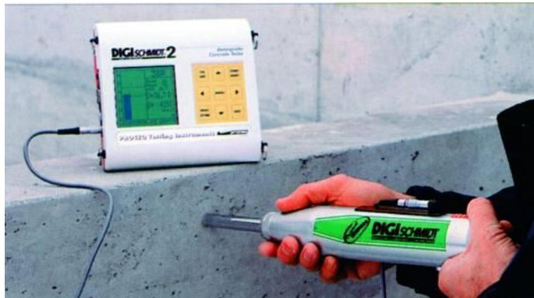
Figura 24. Esclerómetro Convencional. Fuente: IMCYC.
