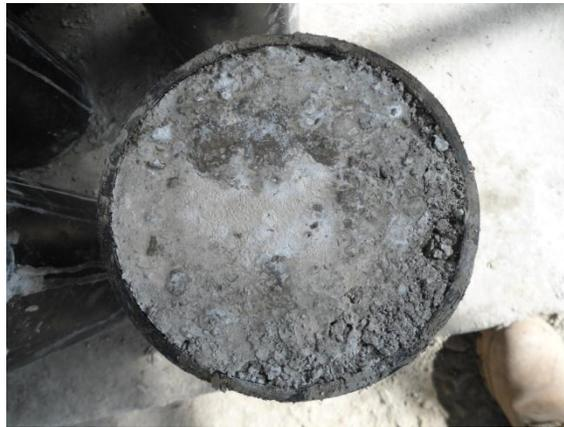
**Figura 15. Secado Prematuro del Concreto. Fuente: Elaboración Propia.**
