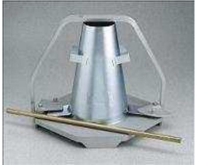
**Figura 11. Cono de Abrams para la determinación del Revenimiento. Fuente: CIGEO UNAN-Managua.**
