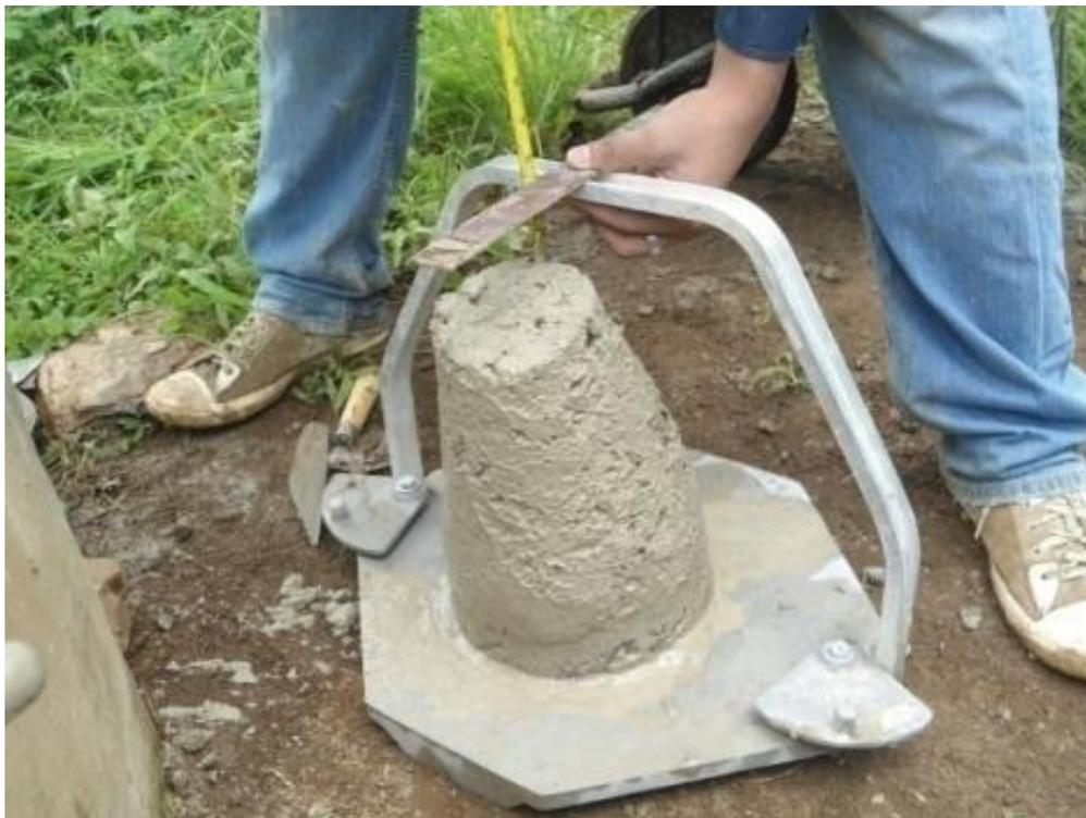
**Figura 29. Determinación del Revenimiento del Concreto usando el Cono de Abrams. Fuente: Elaboración Propia.**
