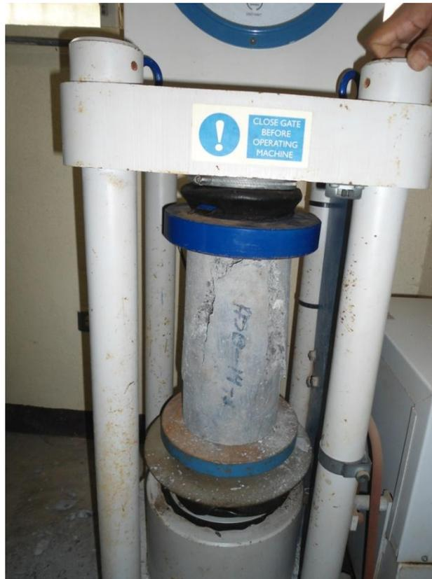
**Figura 23. Prueba de Resistencia a la Compresión del Concreto. Fuente: Elaboración Propia.**
