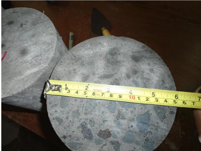
**Figura 38. Determinación del Diámetro de las muestras.**
