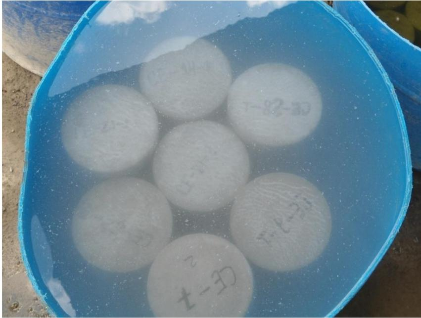
**Figura 33. Curado de las muestras por el método de curado húmedo.**
