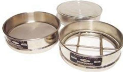
**Figura 8. Mallas o tamices para determinar la granulometría de los agregados. Fuente: Laboratorio CIGEO.**
