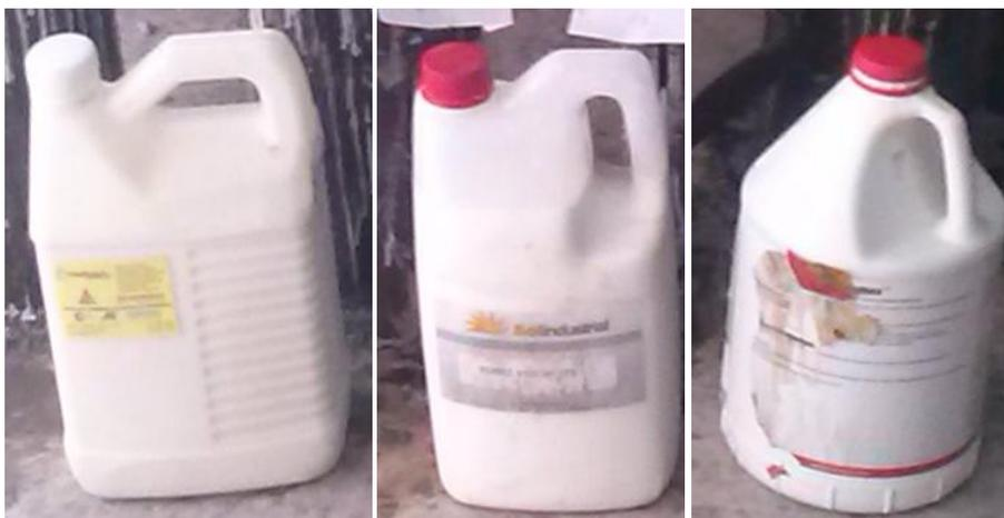
**Figura 36. Curadores de Concreto utilizados en este estudio.**
