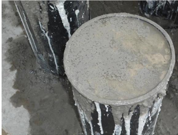
**Figura 14. Fenómeno de Exudación del Concreto. Elaboración Propia.**
