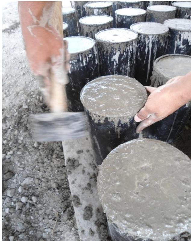
**Figura 31. Llenado de las Muestras de Concreto.**
