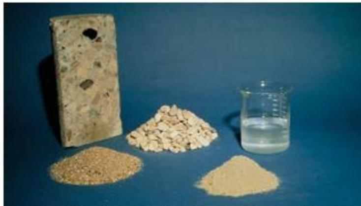
Figura 1. Materiales que intervienen en la mezcla de concreto. Fuente: Laboratorio Holcim.
