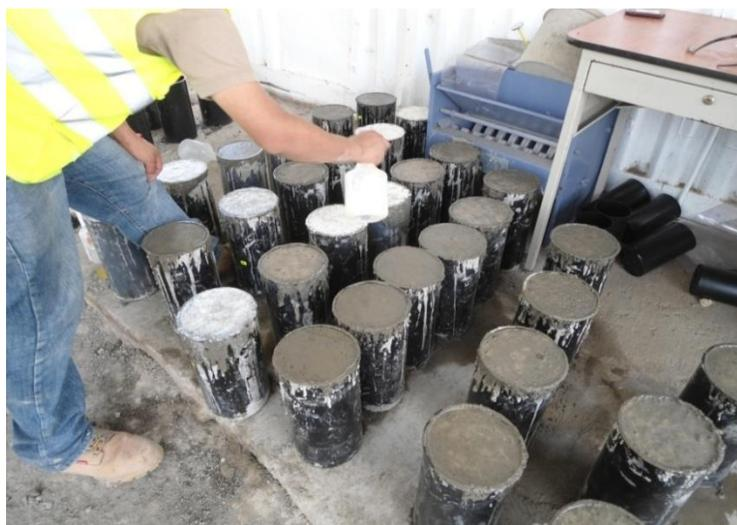
**Figura 35. Curado de las Muestras aplicando membranas de Curado.**
