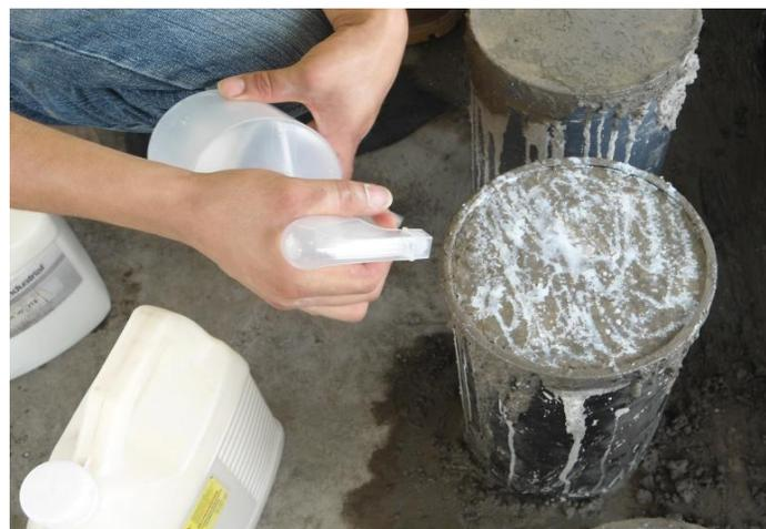
**Figura 34. Rociado o Curado con Líquido Formador de Membrana de Curado.**
