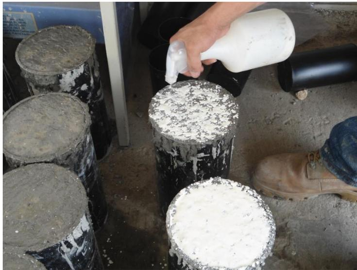
Figura 22. Aplicación de Membrana de Curado utilizada en este trabajo. Fuente: Elaboración Propia.
