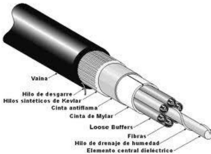
Componentes del cable de fibra óptica.
