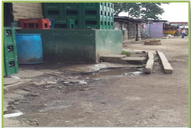
Foto 83; Falta de drenaje pluvial y aguas servidas.
