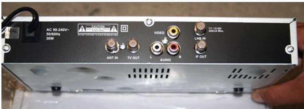
Figura # 55 vista de la parte trasera del decodificador
