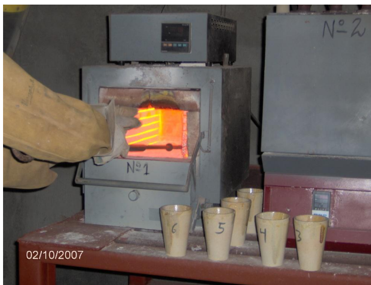
Imagen 9.1.9 Introducción de las muestras en la mufla a 1200 °C
