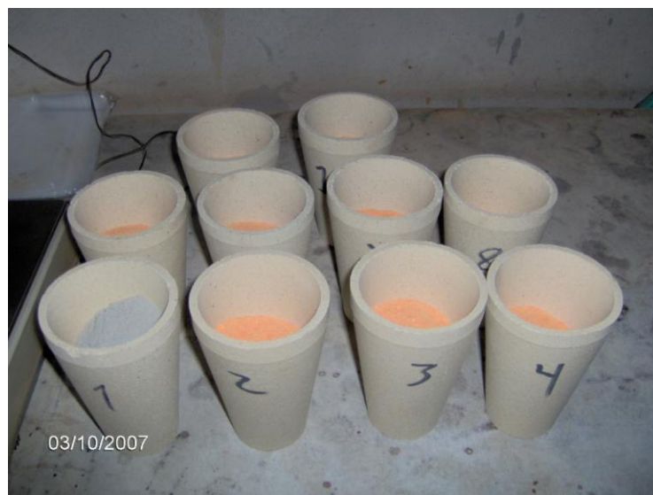
Imagen 9.1.7 Crisoles refractarios conteniendo las muestras sólidas con fundente.
