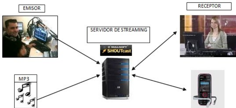
Figura 3.2 diagrama visual entre emisor y receptor de una radio online
