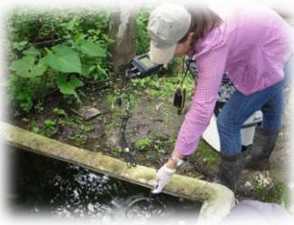
Tomando como referencia las Normas CAPRE, se tomó una muestra de agua en cada fuente identificadas para consumo humano por comunidad, las muestras se colectaron y analizaron *in situ* utilizando un multiparamétrico modelo HANNA HI 9829, equipo que nos permite hacer todos los
