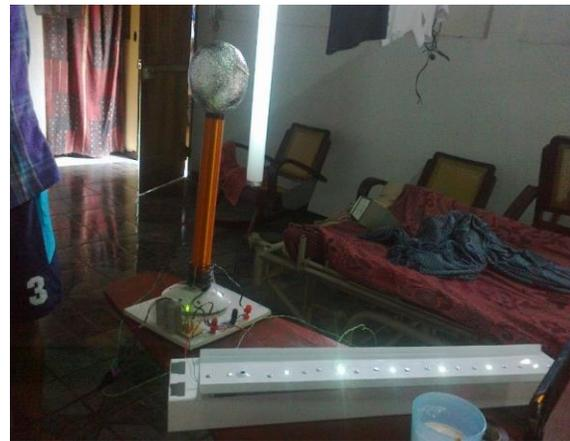
**Figura 15. Prueba del emisor con una lámpara LEDS**
