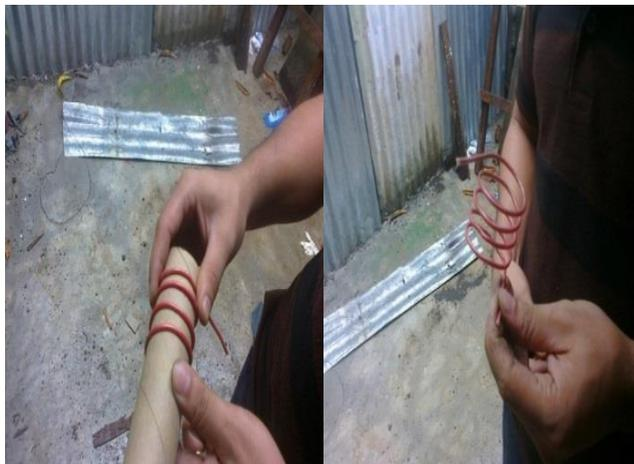
**Figura 12. Elaboración de la bobina primaria**
