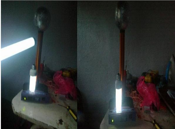
**Figura 14. Prueba del emisor con una lámpara fluorescente**
