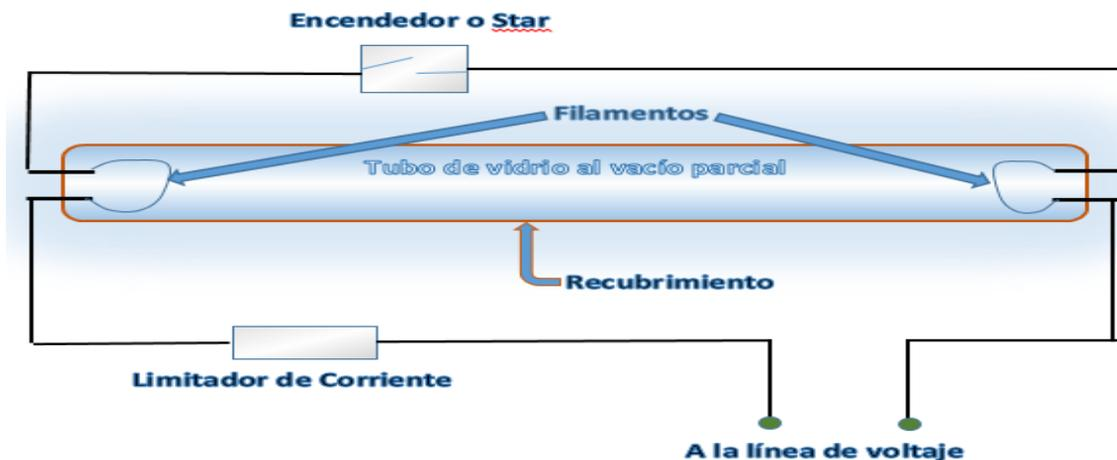
**Esquema 1. Esquema de funcionamiento y elementos de lámpara fluorescente tubular**
