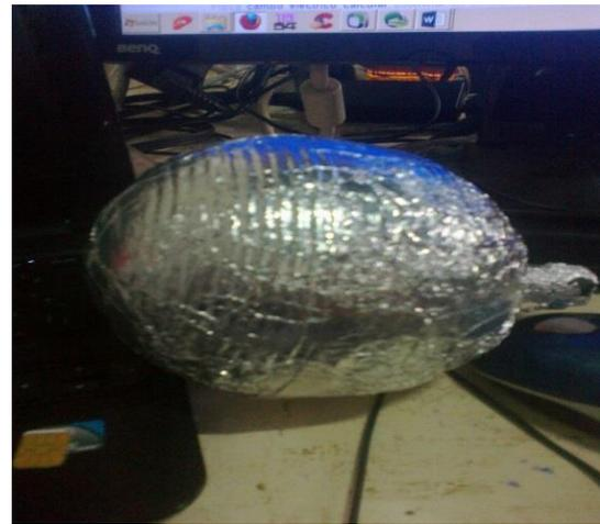
**Figura 11. Carga superior utilizando una boya forrada**
