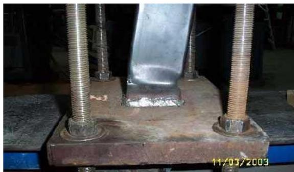
**Figura 3.11 Pandeo local. Tomado de Manual para la inspección visual de puentes y pontones vol.1 (2006) Bogotá, Colombia.**
