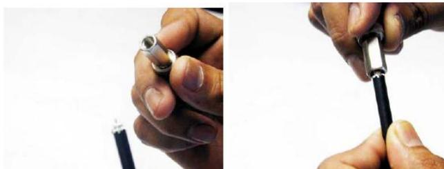
**Figura 20. Adaptación del conector BNC al cable coaxial.**
