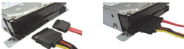
**Figura 22. Cables de conexión entre el disco duro y el DVR**
