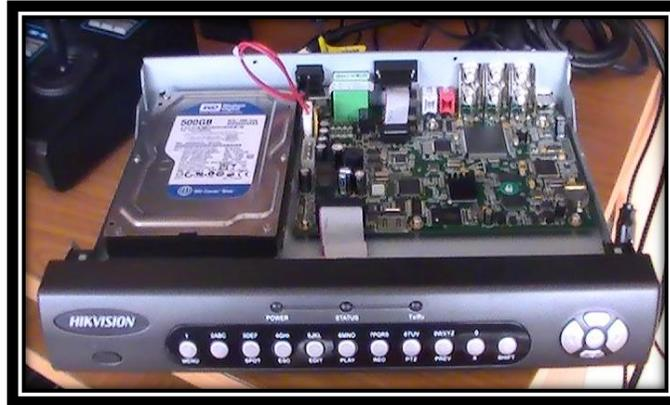
**Figura 25. Conexión de disco duro**
