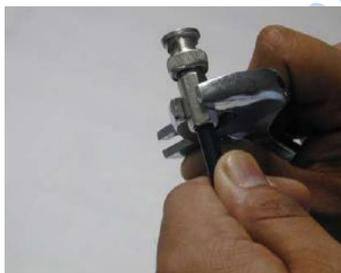
**Figura 21. Enrosque final del conector BNC**
