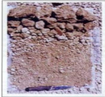
Condición Moderada CV: 1 Presencia de terrones. Hay partículas medianas pequeñas y finas.
