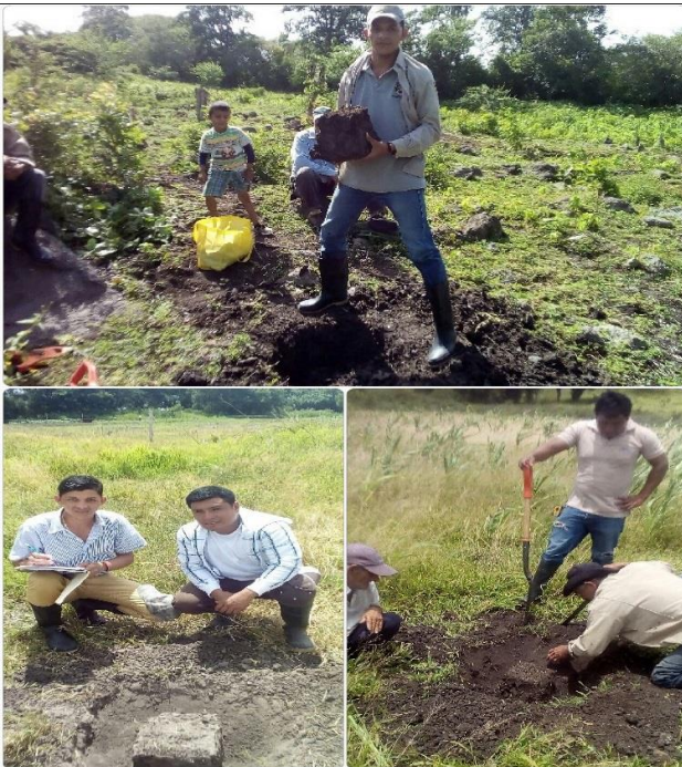
Elaboración de Monolitos para valorar propiedades físicas del suelo
