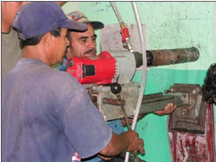
Foto 20.- Prueba de Extracción de núcleos
