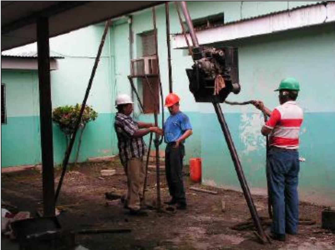
Foto 16.- Ensayo de SPT
