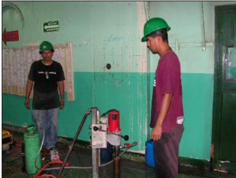
**Foto17.-** Prueba de Martillo Suizo en columna del primer piso
