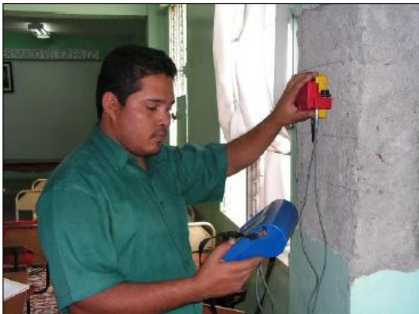
**Foto 18.-** Prueba de Distribución y tamaño de acero estructural
