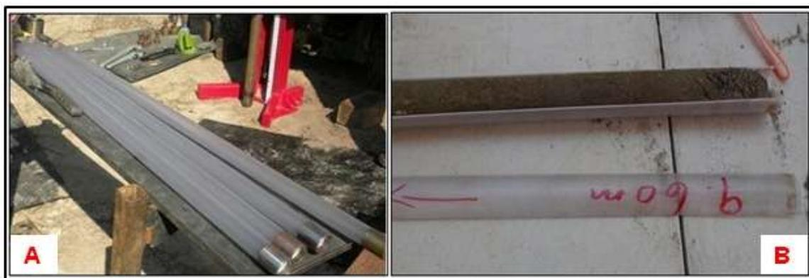
**Foto 4. En la foto A) Se observan los liners usados para la toma de muestras inalteradas. En la foto B) se aprecia una muestra de suelo en un liners una vez extraído de la perforación (EPC, 2008)**
