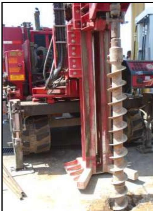
Foto 5. Hollowstem Auger utilizado para instalación de pozos en una perforación (EPC, 2008)
