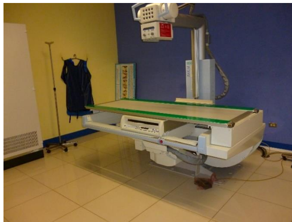
Figura 11: Equipo de fluoroscopia Axiom Iconos R200 Siemens.
