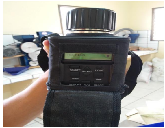
Medidor de Humedad
