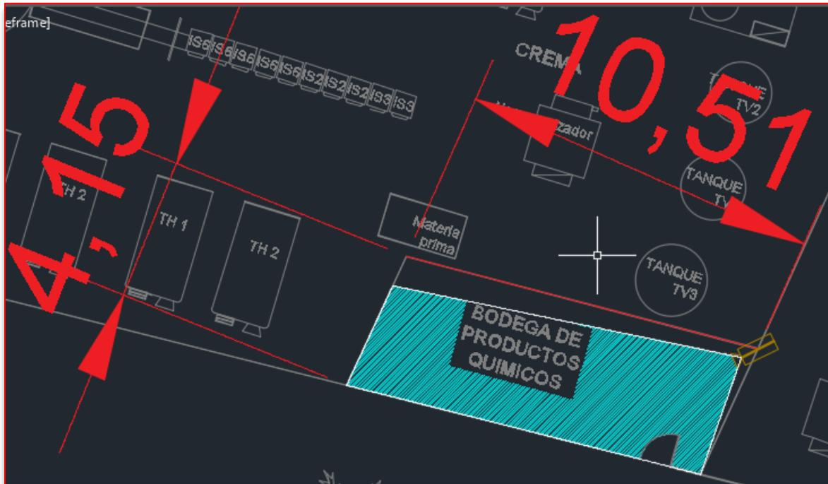
Figura 12. Vista en 2D ubicación de cámara 7 y medidas de área en bodega de productos químicos (AutoCAD).
