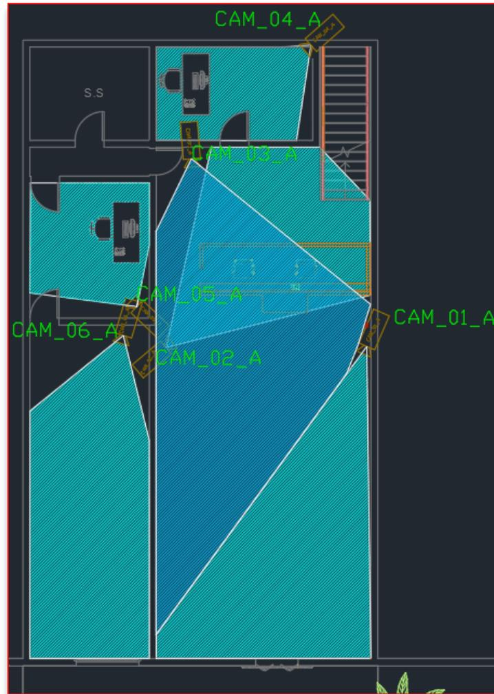
Figura 18. Vista en 2D de propuesta de ubicación de cámaras en almacén (AutoCAD).
