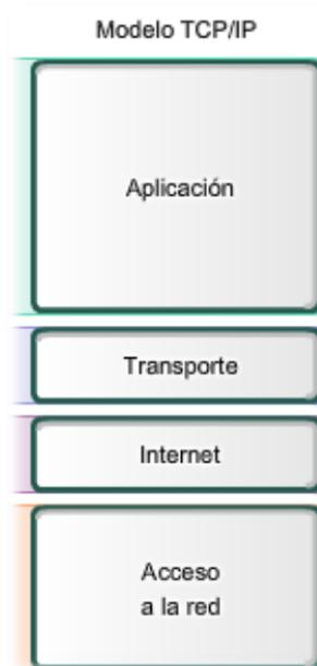
Figura 31. Capas del modelo TCP/IP
