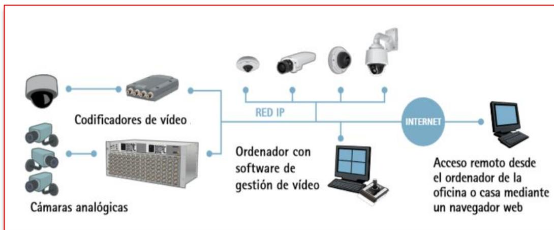
Figura 1. Componentes varios de un sistema de video en red
