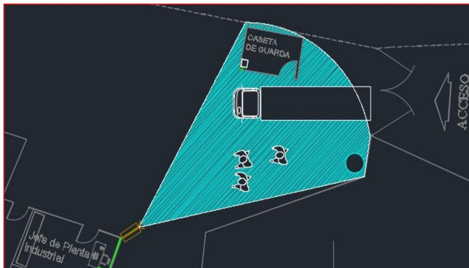
Figura 7. Vista en 2D ubicación de cámara 2 en estructura de oficina del jefe de Planta Industrial (AutoCAD).
