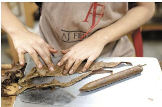
Una vez seca la hoja del tabaco se procede al amarre o torcido de las mismas para formar un habano o puro, el artesano utiliza un tablero, una cuchilla, una guillotina, goma vegetal, una prensa y moldes.
