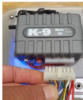
Figura 74: Desconexión y conexión del arnés de alimentación.
