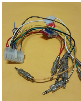
Figura 59: Arnés de alimentación para alarma 150D-LA
