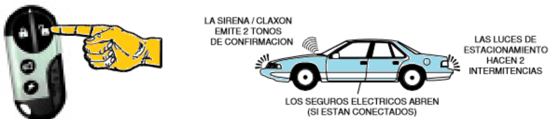
Figura 29: Desarmado de la alarma.
