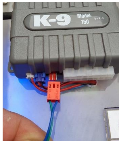
Figura 65: Conexión del arnés de apertura al módulo de alarma k9 150D-LA
