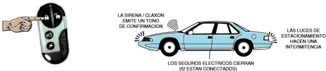
Figura 36: Armado usando transmisor.
