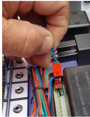
Figura 66: Conexión del arnés de apertura al módulo de alarma K9 Mundial 3
