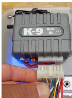
Figura 61: Conexión del Arnés de alimentación al módulo de alarma 150D-LA
