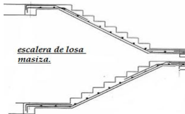
Figura N°25: Escaleras de losa maciza de concreto.
