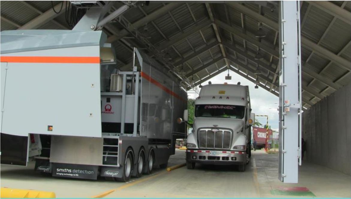
*Foto No.7 Proceso de escaneo al contenedor*
