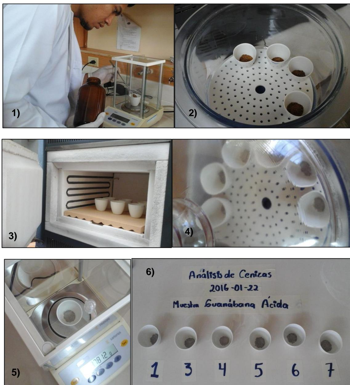
**Figura 25. Análisis de Cenizas:** 1) Peso de la muestra de harina, 2) Muestras pesadas listas para entrar en la mufla, 3) Incineración de las muestras, 4) Muestras incineradas en el desecador, 5) Peso final de las cenizas, 6) Cenizas obtenidas por número de crisol.
