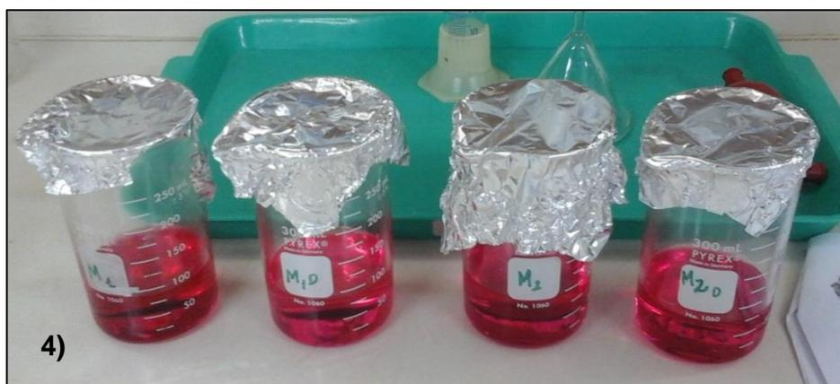
**Figura 29. Análisis de Proteínas, Destilación y Titulación: 1) Micro destilador con muestra digerida, 2) Destilando cada 8 minutos, 3) Titulación y cambio de color de la muestra, 4) Color final de la muestra.**
