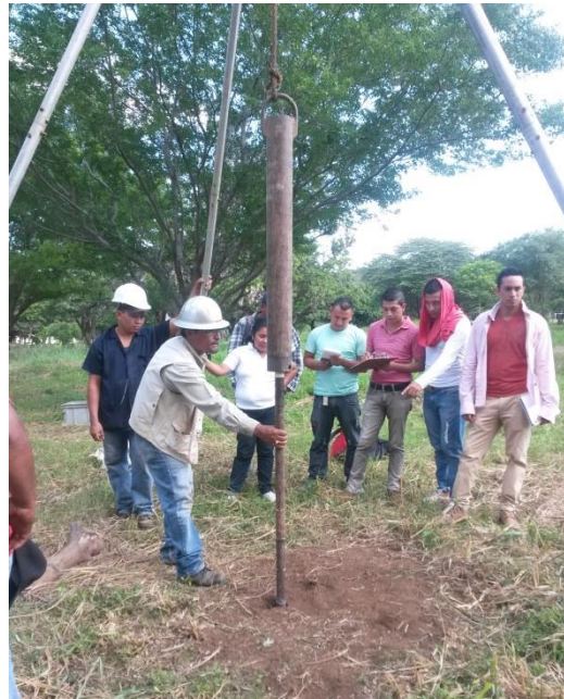
d) Ejecución de la prueba SPT
