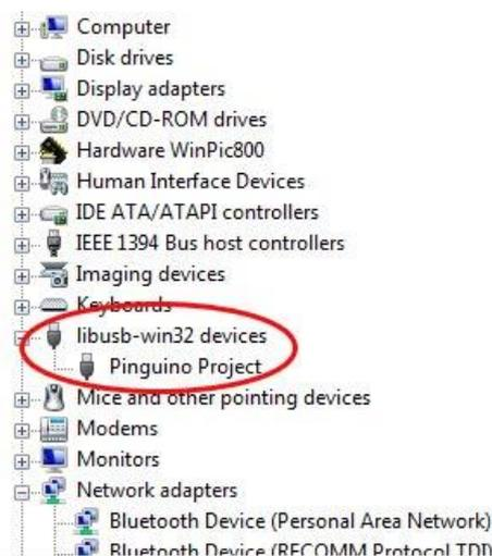
Fig.3.5.1(a): Driver de pingüino instalado en el administrador de dispositivos.
