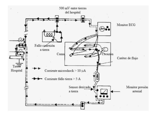
Figura 20 Equipos conectados a diferentes potenciales de tierra (Instrumentation, s.f.)
