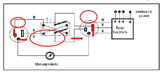
Figura 12. Circuito para medir la corriente de fuga a través del tercer conductor Rodríguez, E. y otros.
