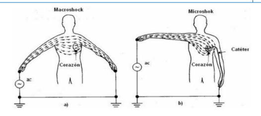
Figura 16 Efectos de los puntos de entradas en la distribución de la corriente por el cuerpo(J W. I., s.f.)
