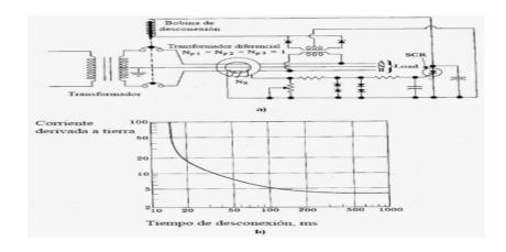
Esquema 3 .1 Esquema de un monitor de falla a tierra (GFCI).
