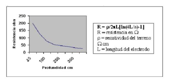
Figura 7 Variación de la resistencia en función de su profundidad
