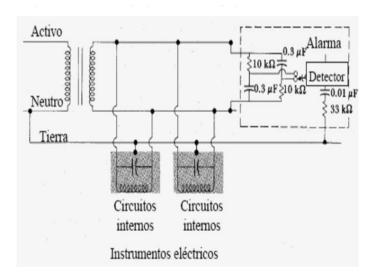
Esquema 2 Sistema de alimentación con aislamiento por transformador con un monitor de aislamiento de línea para detectar deriva o tierras.
