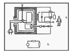
Figura 23 La protección de la clase II incide sobre el parámetro de la impedancia de aislamiento.(Electromedicos, s.f.)
