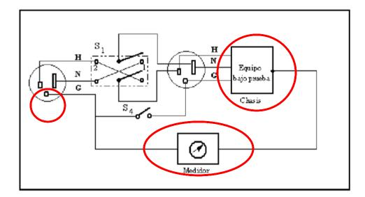
Figura9 Circuito para medir las corrientes de fuga del chasis Rodríguez, E. y otros. Seguridad eléctrica en el diseño de Equipos Electro médicos. Ingeniería Electrónica, Automática y Comunicaciones.
