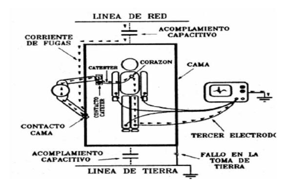
Figura 19 Superficie no conectada a tierra.
