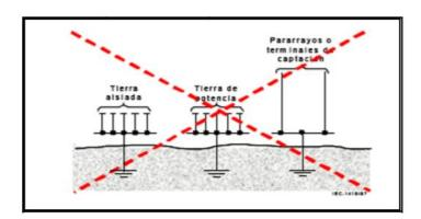
Figura6. Una sola puesta a tierra separada o independiente.(https://minminas.gov.co/retie, s.f.)
