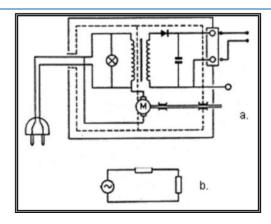
Figura 24. Equipo de clase III. a) En trazo negro lo que caracteriza a estos equipos. b) Circuito equivalente.
