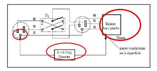
Figura8. Esquema de medición de resistencia entre terminal de tierra y chasis
