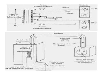
Esquema 1 Esquema simplificado de la distribución eléctrica
