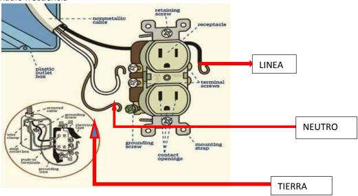
Figura1 Conexión de un toma corriente puesto a tierra.(faradayos.blogspot.com, s.f.)
