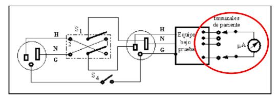
Figura 10. Circuito de medida para la corriente de fuga entre terminales de paciente., E.y otros Seguridad eléctrica en el diseño de Equipos Electro médicos I. Ingeniería Electrónica, Automática y Comunicaciones.
