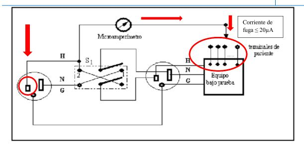
Figura11 Circuito para medir la corriente de fuga que circularía si apareciera el voltaje de línea sobre el paciente .Rodríguez, E. y otros. Seguridad eléctrica en el diseño de Equipos Electro médicos I. (Rodriguez E. o., s.f.)Ingeniería Electrónica, Automática y Comunicaciones.
