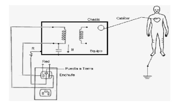
Figura 13 Disminución de las corrientes de fuga a través de paciente mediante tercer conductor a tierra (clinica, s.f.).
