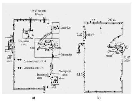
Figura 21a) Riesgo de microshock debido a la existencia de equipos conectados a diferentes potenciales de tierra 21 b) circuito Equivalente.., 1992. (Medical, s.f.)
